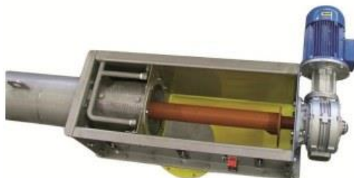
Foto Ilustrativa da Zona de Compactação
